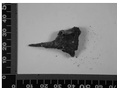
図 3.1.83 船底穴の辺縁部 つらら状の部分 (A)
