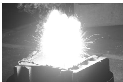
図 3.2.17 マグネシウム／酸化第二鉄のテルミット反応
