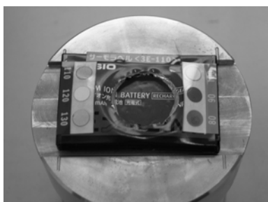
図 3.2.8 示熱テープを貼ったリチウムイオン電池の落つい感度試験結果
