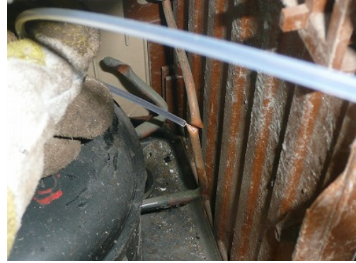
(2) コンプレッサー内の残留ガスのサンプリング
