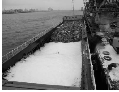
図 3.1.47 高発泡タイプ 泡消火の状況
