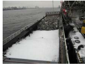
高発泡タイプ泡消火の状況
