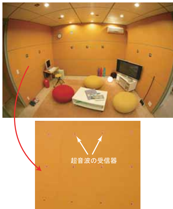
図2 超音波3次元タグシステムを実装したセンサルーム Fig.2 Sensor Room of Ultrasonic 3D Tag System
