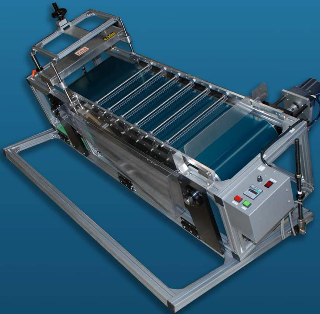
廃電子素子のうち円筒形のアルミ電解コンデンサを形状選別、
