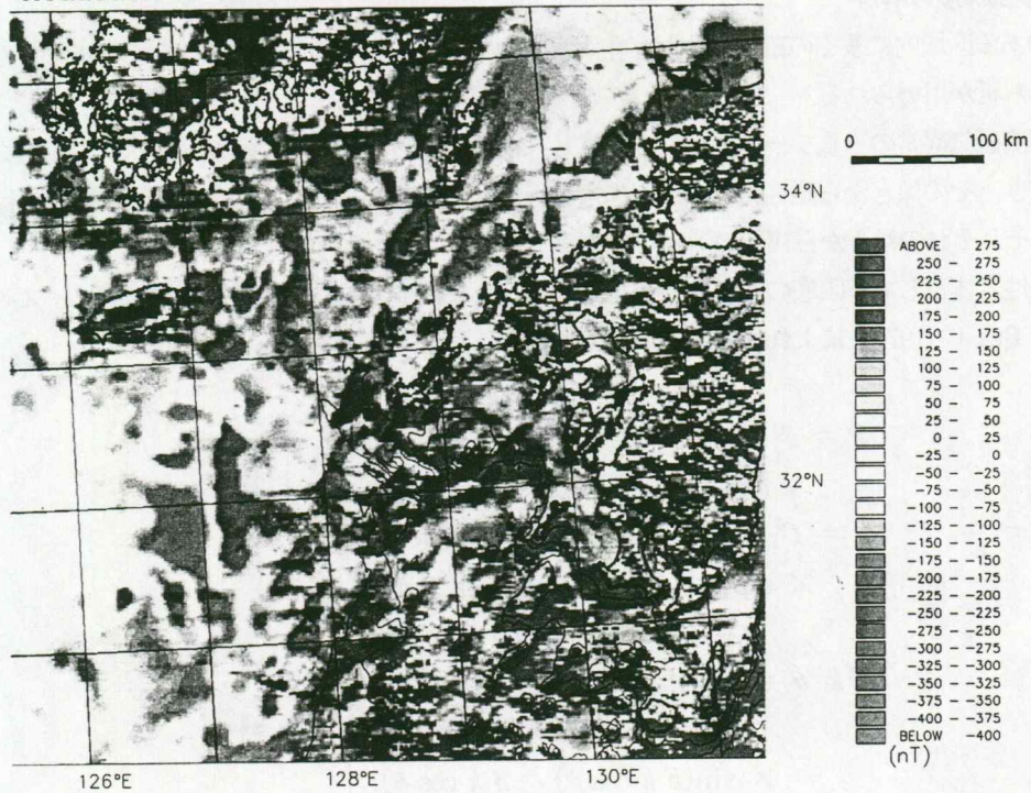
図 4.1 九州西方海域における極磁力異常図 (大熊ほか, 1996) 地形の陰影を重ねてある。東海陸棚外縁部に高磁気異常が連続するのが分かる。 コンター間隔: 25 nT
