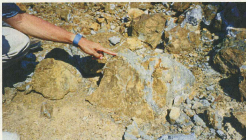
図 3-5 stock work のクローズアップ。熱水の流路が網目状になる。
