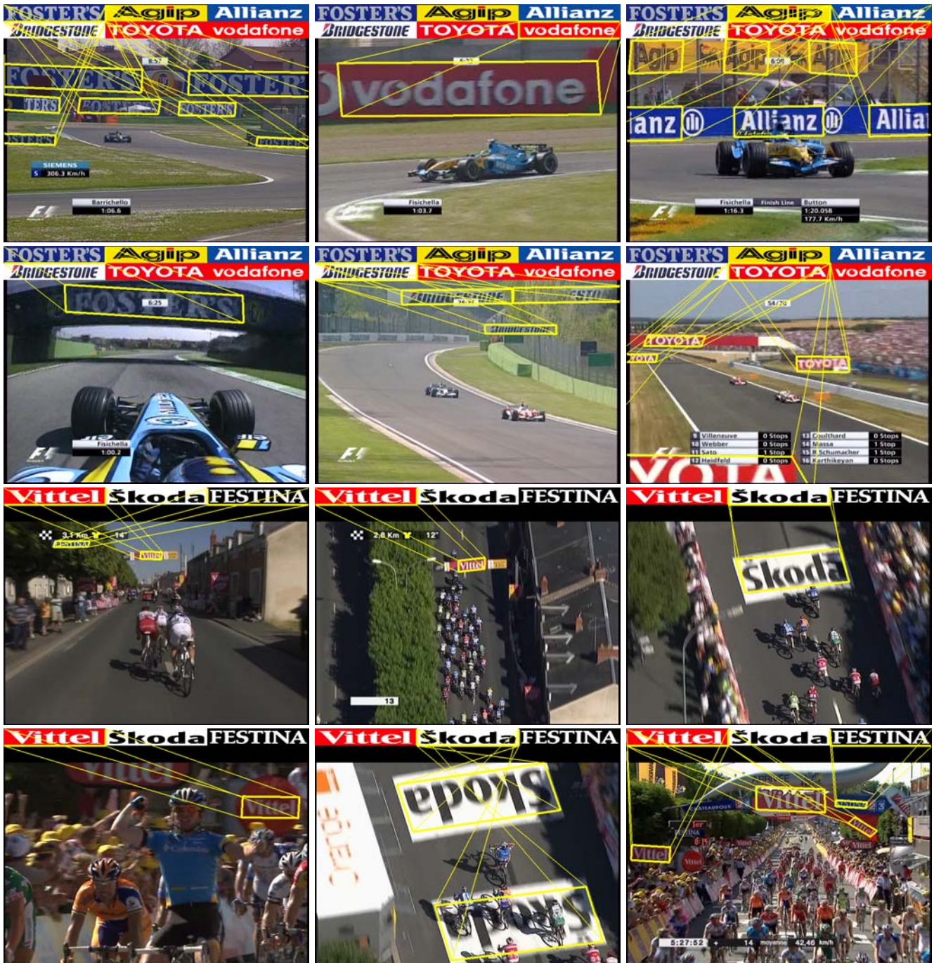
図 5: GPU による実装により抽出された特徴量を使用した、放送映像でのロゴの検出結果。検出は、文献 [10] の対応付けに基づくアルゴリズムで行った。ロゴのモデル画像は、各結果の上部に示してある 1 枚のみを用いた。モデル画像からの見えの変化や隠れにもかかわらず、ロゴの面積と位置の算出が可能である。
