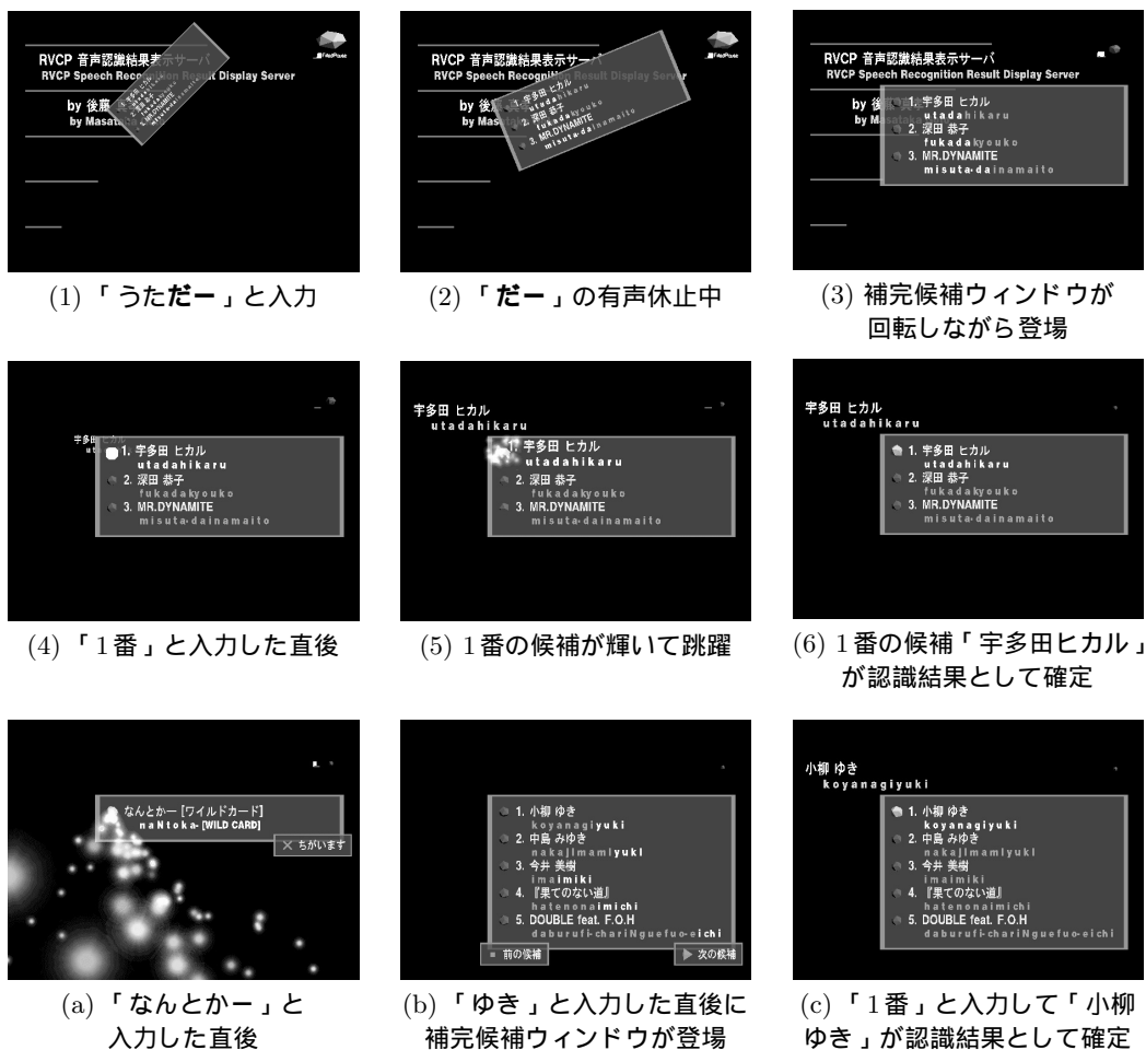
図 5. 音声補完中の画面表示例: (1) ~ (6) が音声フォワード補完の例, (a) ~ (c) が音声バックワード補完の例
