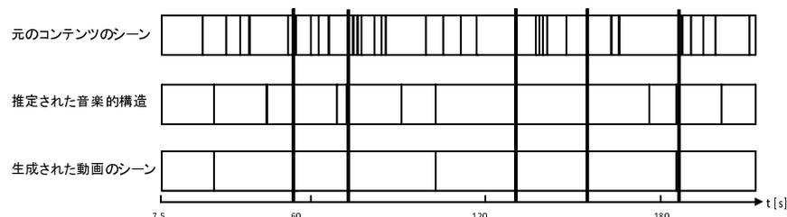
図3 本システムによって生成された動画の時間的連続性(下)、RefraiD<sup>12)</sup>によって推定された音楽的構造(中)、人間による同一楽曲の再構成動画の時間的連続性(上)を示す。図中、五箇所(太線の箇所)において、それぞれ三つの結果が揃っていることを示す。
