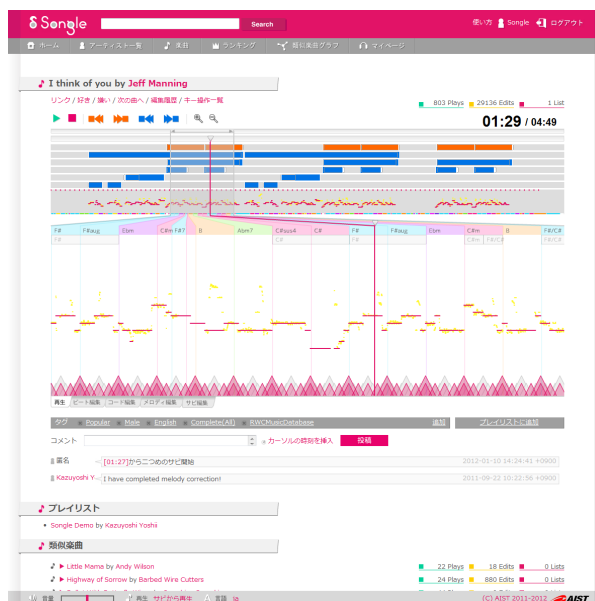
図 1 Songle の中心的な機能である音楽再生用インタフェースの画面表示例．自動推定された音楽情景記述も可視化されている． Fig. 1 Songle screen snapshot of the main interface for music playback with the visualization of music scene descriptions estimated automatically.
