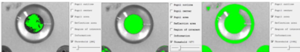
瞳孔だけが閾値以下になる真ん中の図が最適な設定である。固定値で運用する場合は、このまま、自動的に閾値を追従させる場合は、Threshold前のチェックを外す。Informationのチェックを入れることで、画像のヒストグラムと現在の閾値の値を見ることが出来る。左側の赤い棒が現在の閾値を表し、反転表示している部分が輝度のヒストグラムである。瞳孔は最初のピークとして現れるので、最初のピークを過ぎた谷の部分が適切な閾値となっていることがわかる。
