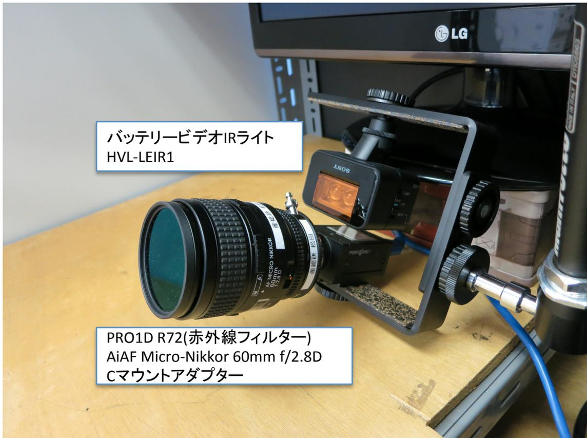
カメラは、USB3.0接続のGrasshopper3 (GS3-U3-41C6NIR-C) を推奨する。Flea3 またはFirewire800接続のGrasshopperの使用も可能。FireWire800接続のGrasshopperは駒落ちのない安定した動作が期待できる。USB3.0接続カメラは高速撮影が可能だが駒落ちが発生する場合がある。Grasshopper3は、1inchのCMOSを使用しているので、それに対応したレンズを用ること。バッテリービデオIRライトは、光量を調節でき、充電式の電池が使用可能。照明器具として監視カメラ (AVC-1004) を用いることもできる。こちらは、AC電源で作動するので長時間の使用に向いている。環境光に応じて照明を変化させるため、常に赤外線を照射するためには、環境光センサー部分にアルミホイルなどで覆いをする必要がある。その他、照明を自作するのであれば秋月通商などから購入することができる。
