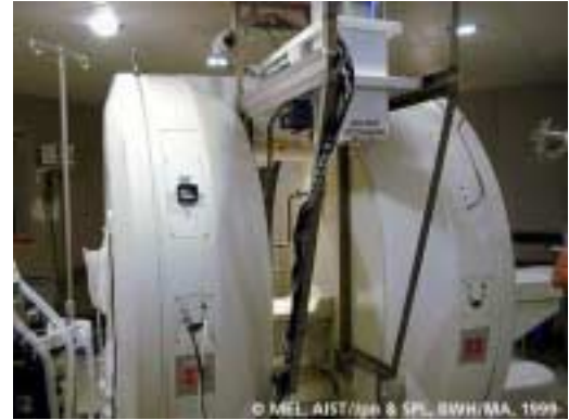
図4 開発したMR compatible手術支援ロボット機構
