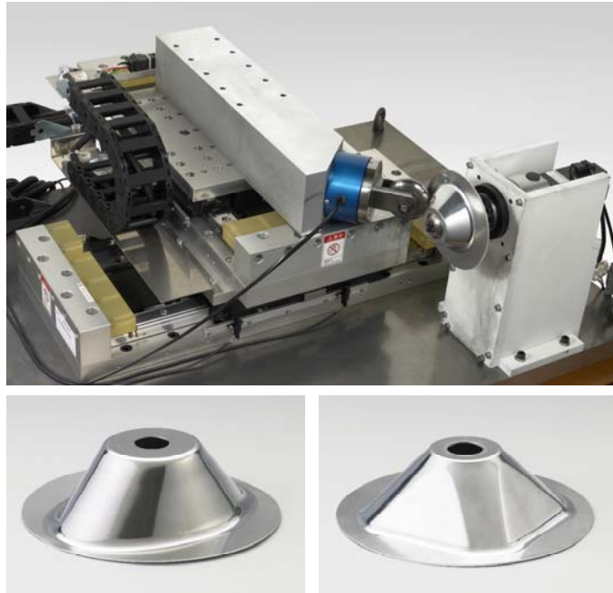
図4 リニアモータ駆動スピニング加工機（実験機）と成形例 http://staff.aist.go.jp/h.arai/linspin_j.html
