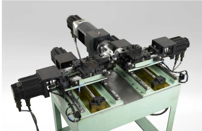
a) 2ローラ式スピニング加工機
