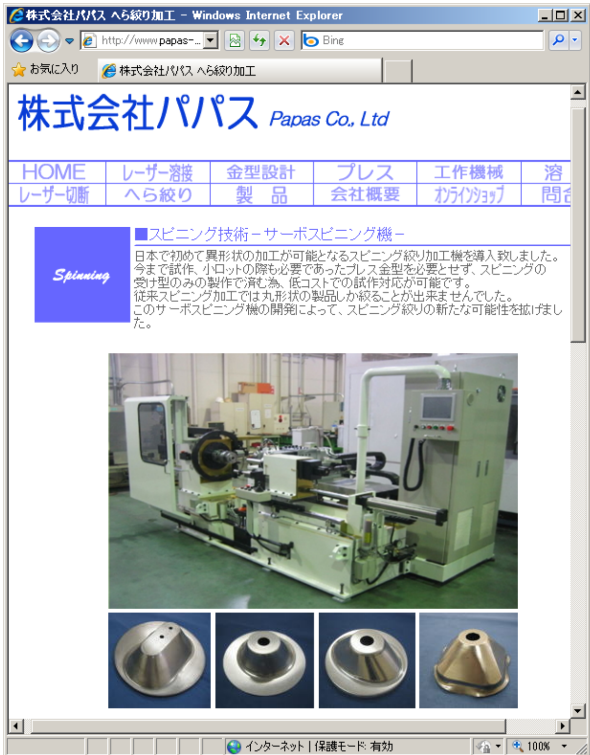
図8 企業に導入された異形スピニング加工機 (株式会社パパス http://www.papas-kk.co.jp/hera/hera.htm )
