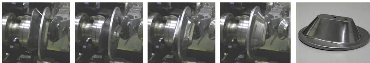
力制御スピニングによる成形（冷延鋼板 厚さ1.2mm）
