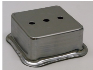
冷延鋼板 厚さ1.6mm
