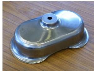
冷延鋼板 厚さ1mm
