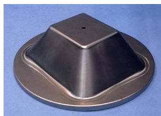
冷延鋼板 厚さ1.2mm
