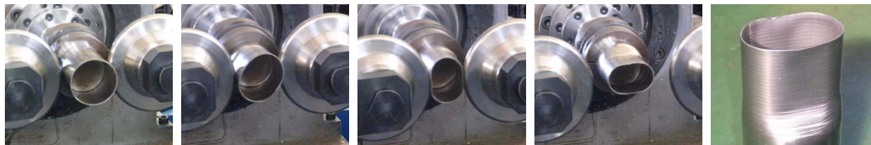
同期スピニングによる成形（ステンレス 厚さ1.5mm）
