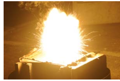
(3) マグネシウムのテルミット 反応実験 (参考)
