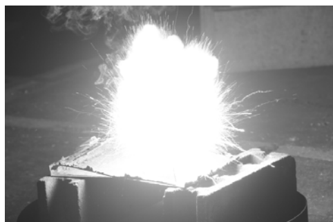
図 3.2.2 マグネシウム／酸化第二鉄のテルミット反応
