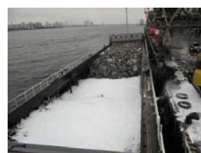
高発泡タイプ泡消火の状況
