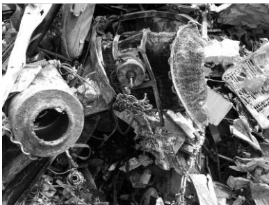
図3.1.13 モータ、 アルミ放熱板
