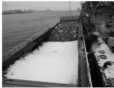
図3.1.11 高発泡タイプ 泡消火の状況
