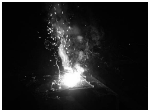
図 3.2.1 マグネシウムリボンに着火後のアルミニウム／酸化第二鉄のテルミット反応
