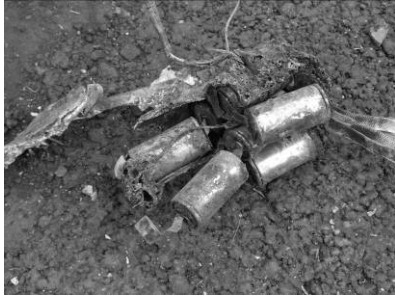
図3.1.19 電池パック (電極に溶融アルミ付着)
