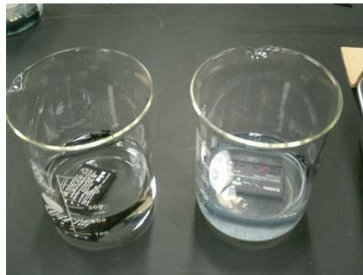
図 11 純水 (左) と海水 (右) 中のリチウムイオン電池浸漬試験 (ほとんど、温度上昇が見られなかった)
