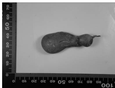
図3.1.23 溶けた金属片(B)
