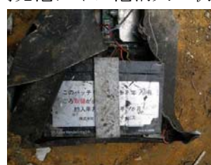
鉛バッテリー (UPS)
