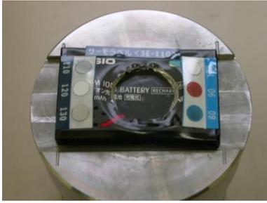
図 3.2.2 示熱テープを貼ったリチウムイオン電池の落つい感度試験結果
