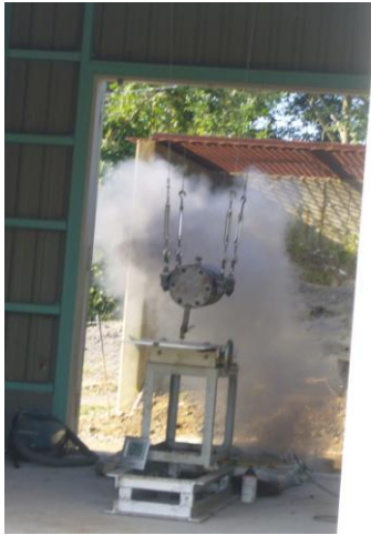
図 3.2.7 弾動臼砲試験の様子
