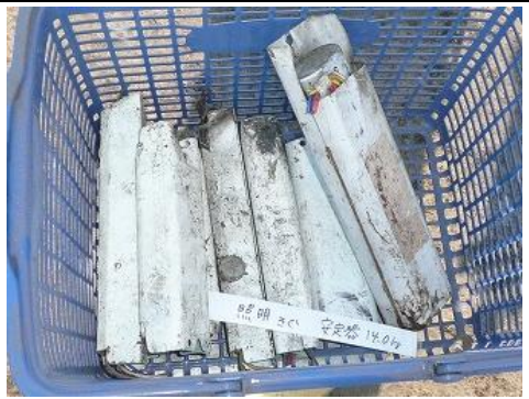
I-32 照明機器部品・安定器
