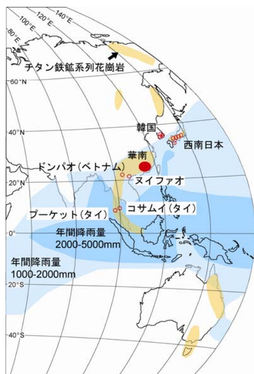
図1 東アジア地域のチタン鉄鉱系列花崗岩の分布と年間降水量。開発されたイオン吸着型鉱床の分布域を赤色域で、調査地域(予定地域を含む)を赤円で示す。
