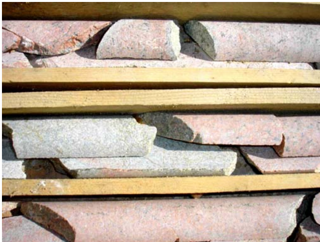
第 10 図 ツァガンスバルガ鉱床での花崗閃緑岩の熱水変質の産状。赤色部はカリウム変質、白色部は白雲母変質を蒙った部分。白色部に黄鉄鉱や黄鉄鉱、輝水塩鉱が認められる。
