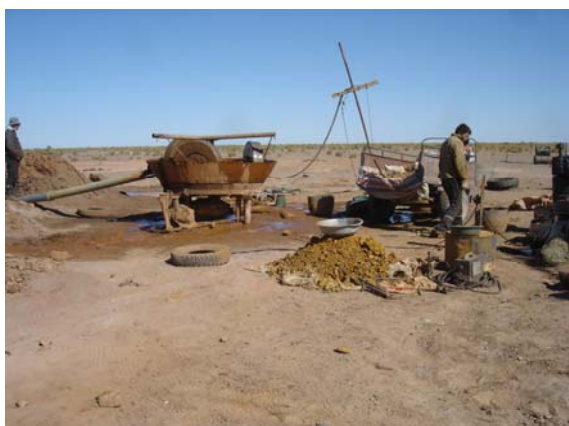
第 21 図 忍者の鉱石粉碎施設。ここで砕かれた試料はリーチングプールに運ばれる。
