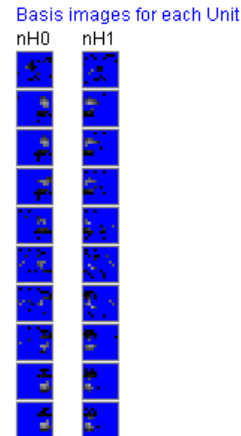
図 9.9: 特徴数を 20 ピクセルに制限した場合の各ノードの基底画像。青いピクセルはその特徴が選択されていないことを意味する。
