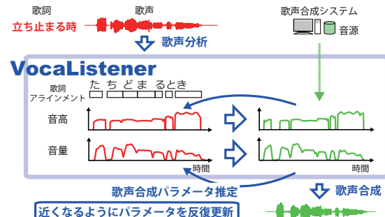
図2 VocaListener の処理概要。人間の歌声と歌詞を入力として、その歌い方に近くなるように歌声合成パラメータを反復推定して歌声合成する。
