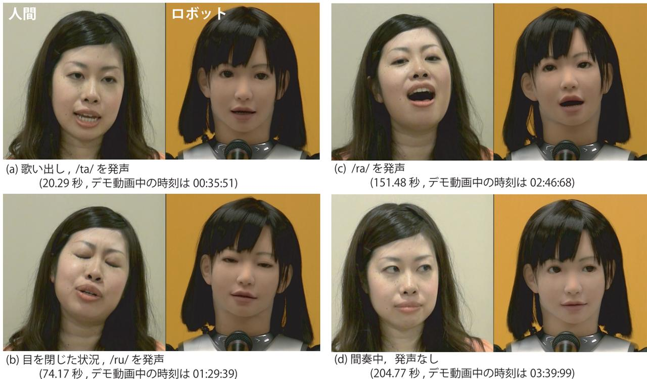
図 16 人間の歌手の顔(左)と提案手法によって顔動作を生成した HRP-4C の顔(右)
