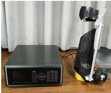
図 3: 超音波モータコントローラ (左) とパワーアシスト用装具 (右)
