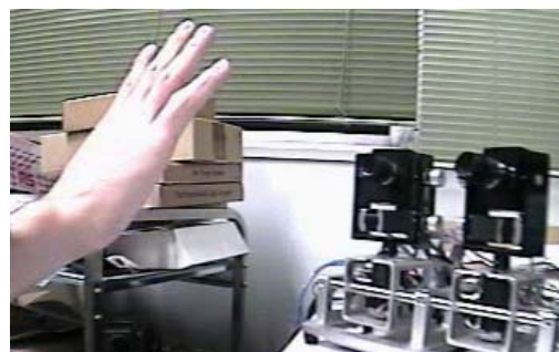
図 1: 両眼ロボットビジョンシステムの外観写真。
