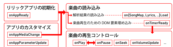
図 2: 本フレームワークは, リリックアプリの複雑な状態遷移を管理するためのイベント駆動型 API を提供する。
